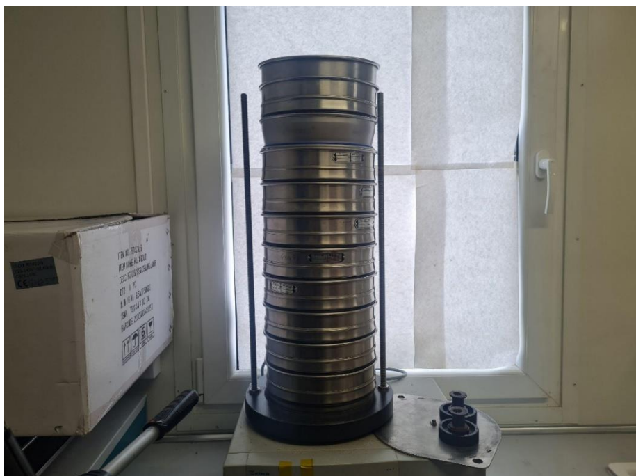
4.2. Attēls. Sijātājs Retsch GmbH AS 200 smilšu granulometriskā sastāva noteikšanai (Foto: LHEI)
