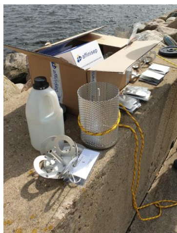
2. Attēls. POCIS sagatavošana darbam pirms iegremdēšanas (A); POCIS diska gaisa ekspozīcija manipulāciju laikā (B); apaugums uz POCIS diskus pēc ekspozīcijas ūdenī (C). Foto: R. Poikāne
