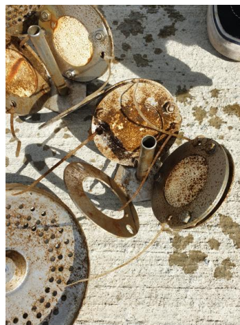
2. Attēls. POCIS sagatavošana darbam pirms iegremdēšanas (A); POCIS diska gaisa ekspozīcija manipulāciju laikā (B); apaugums uz POCIS diskus pēc ekspozīcijas ūdenī (C). Foto: R. Poikāne
