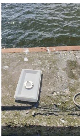
2. Attēls. POCIS sagatavošana darbam pirms iegremdēšanas (A); POCIS diska gaisa ekspozīcija manipulāciju laikā (B); apaugums uz POCIS diskus pēc ekspozīcijas ūdenī (C). Foto: R. Poikāne
